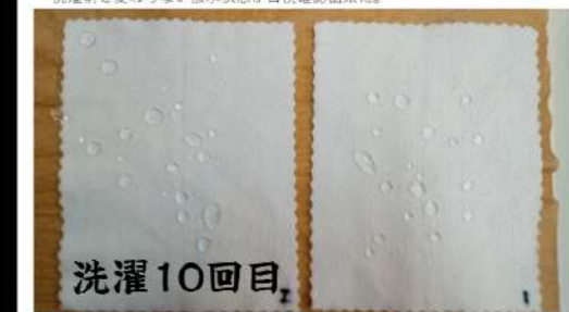
■弊社【洗濯10回目】 家庭用洗濯機にて洗濯、乾燥後に水滴を垂らした。 洗濯前と変わらない撥水状態が目視確認出来た。
