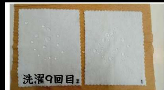
■弊社【洗濯9回目】 家庭用洗濯機にて洗濯、乾燥後に水滴を垂らした。 洗濯前と変わらない撥水状態が目視確認出来た。
