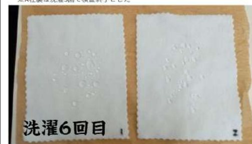
■弊社【洗濯6回目】 家庭用洗濯機にて洗濯、乾燥後に水滴を垂らした。 洗濯前と変わらない撥水状態が目視確認出来た。
